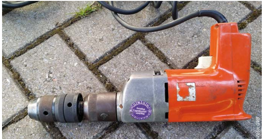
Abbildung 6: Arbeitsmittel Bohrmaschine mit Prüfplakette
