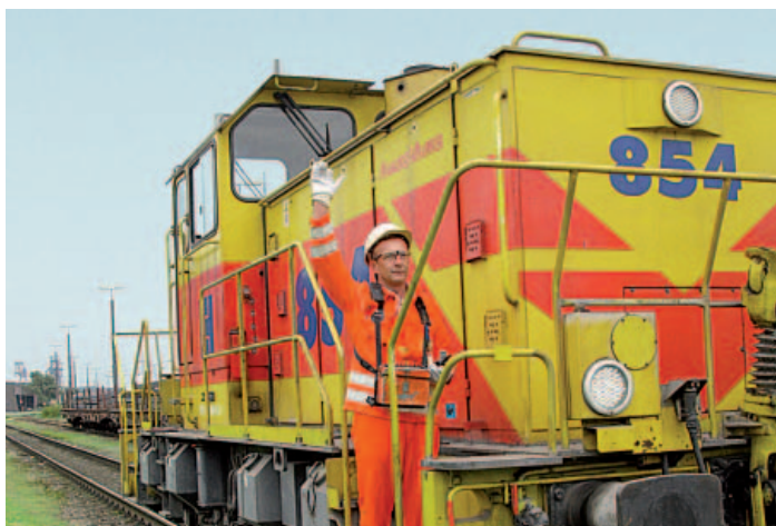
Abbildung 11: Bei der Hörprobe des Lrf hat sich bewährt, das Wahrnehmen der Signale durch das Heben der Hand zu bestätigen.
