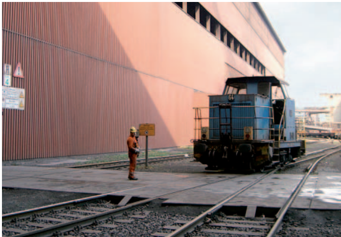
Abbildung 1: Soweit an Bahnüber- wegen in abgeschlos- senen Werksbereichen zu deren Sicherung Typhon- oder Läute- signale abgegeben werden müssen, führt dies zu erheblichen Lärmbelastungen für den Lrf.
