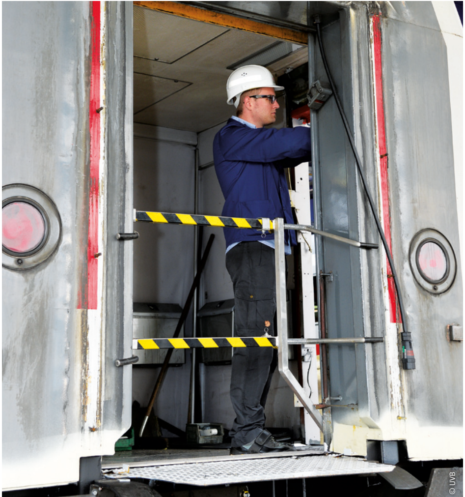
Abb. 6: Absturzsicherung am offenen Wagenübergang
